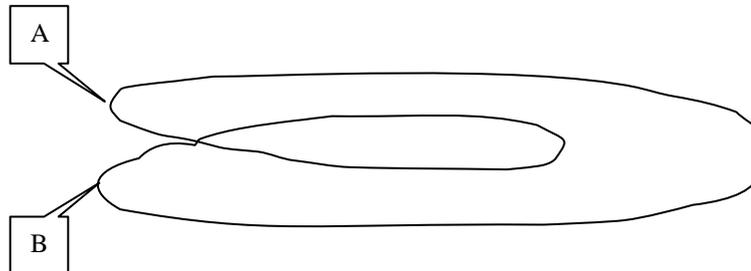
Un impulso  $\delta(t)$  (delta di Dirac) applicato fra A e B dà luogo ad una serie di impulsi che si presentano a segni alterni fra i punti A e B, ad intervalli di tempo  $2\tau$  che in questo caso sono pari a una distanza  $\lambda_c/2$  percorsa alla velocità della luce. In formula:
