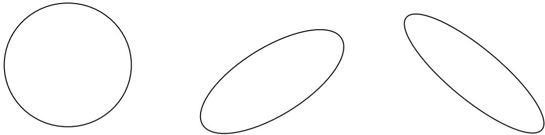
La più generale definizione di polarizzazione comporta pertanto la definizione di un'ellisse di polarizzazione, il quale fornisce tutti i casi possibili, in particolare i casi estremi di lineare verticale, lineare orizzontale, circolare destra e circolare sinistra.
