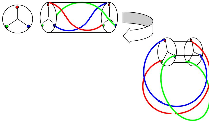
Una volta fatti i collegamenti, la spina tripla di arrivo, quella di destra, verrà ruotata di 360 gradi e richiuderà il collegamento.
