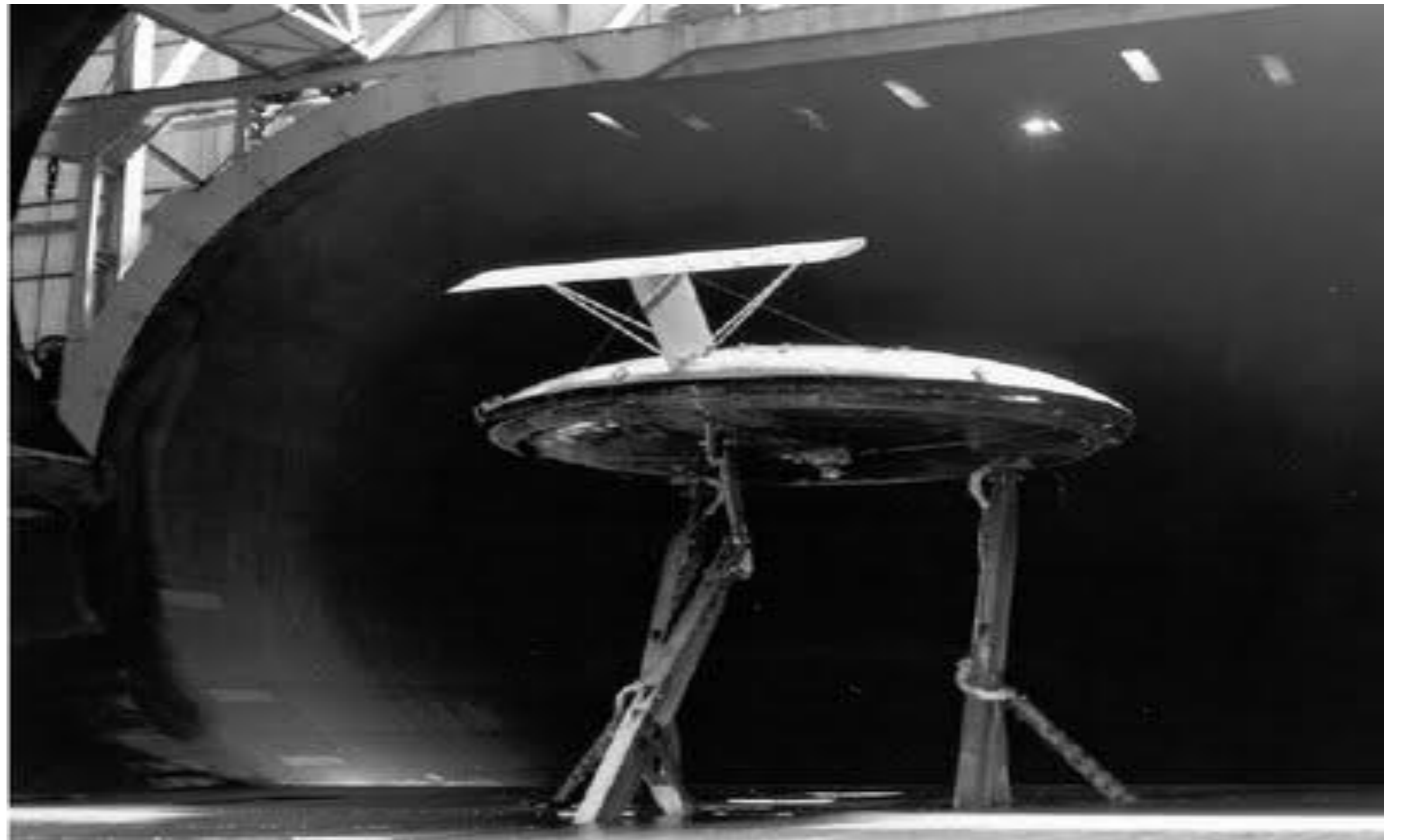
Foto 3. Avrocar com uma empenagem em T adicionada.
