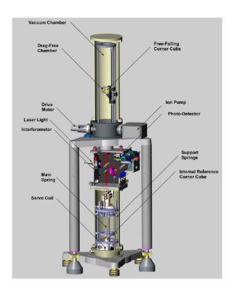
FIG. 1. FG5 gravimeter
