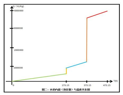
由表一、表二和图二可知:水的温度与其所携带的热量并非简单的线性关系。在水由固体 变为液体或由液体变为气体时,热量与温度间的关系为多值关系。因此,并不能直接用温度来 表示同一物质热量的高低!必须考虑物质的状态,也就是分子或原子的运动状态及相互间关系。 物体的温度高低虽然与其分子热运动主频正相关,也与分子热运动平均速度、动量和动能正相 关但非单值函数关系。同样温度的水和冰或水和水蒸气混合物的分子热运动平均速度、动量和 动能可以有很多个值。
