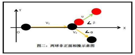
假设运动球和被撞球的质量均为 m、碰撞前运动球的速度为 v<sub>1</sub>;碰撞后运动球的速度为 v<sub>2</sub>、 被撞球的速度为 u、运动球运动方向改变角度为 α、被撞球运动方向与运动球撞击前运动方向 间夹角为 β。则有:
