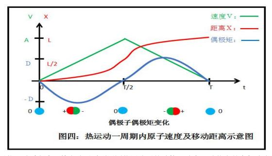
分子热运动过程中,特定分子受到周围临近分子的冲撞而改变运动状态并变加速直线运动, 直到另一侧其他分子阻碍而发生变减速直线运动直至暂时停止运动,此过程即为分子热运动的 一个周期。而分子中的原子在此期间的受力如上图三所示:受冲撞初期,电子最先受力并改变 运动状态,电子运动状态的改变迫使原子核发生运动状态的改变。此期间会使原子成为一电偶 极子。当运动一定距离后,电子与原子核的运动速度同步时,原子又恢复到了电中性状态;再 运动一段距离后会受到另一侧临近分子的阻碍而发生减速运动。如开始正好相反,电子最先开 始减速运动并迫使原子核也进入减速运动,此过程中原子又成为一电偶极子,但极性与前面正 好相反。直到原子暂时停止运动时,原子又恢复到中性状态。因此,分子一个周期的热运动会 使其中的原子两次成为电偶极子,也就会向外辐射两次电偶极子电磁场,也正好完成一个周期 的电磁辐射,即热运动频率与辐射频率相等。详见上图四所示。
