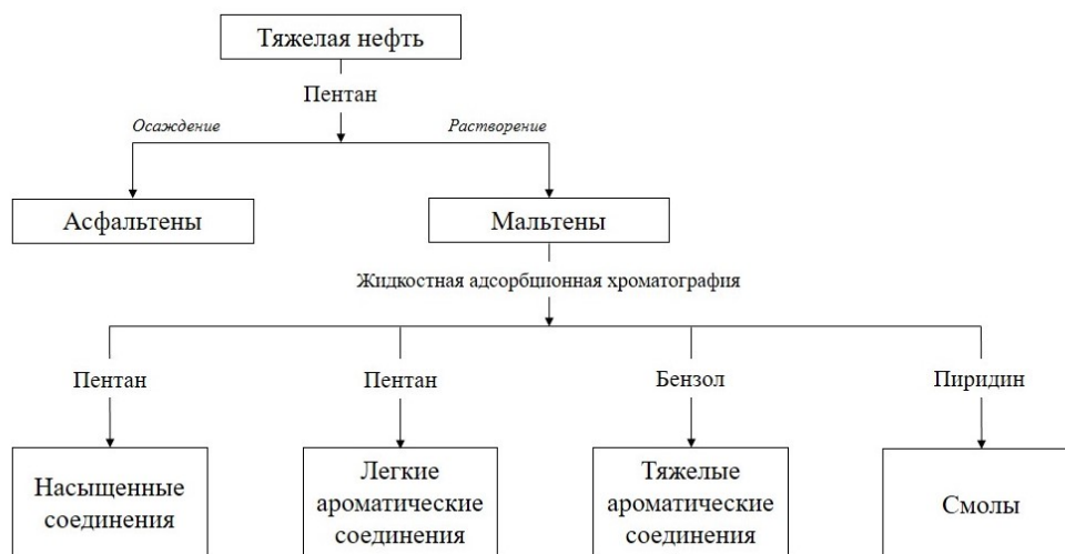
Рис. 1. Схема приготовления основных фракций тяжелой нефти.
