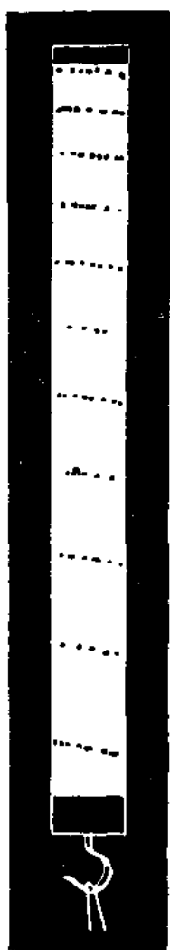
Рис. 24. Падающее тело с отметками времени и их обработка с обычными ошибками опыта и отсчета. Этот опыт показывает прежде всего, что измерение второй производной — дело довольно неприятное, пока не применяется фотографическая регистрация.
